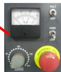
Instruments de mesure, arrêt d'urgence et Sélecteur des avances
