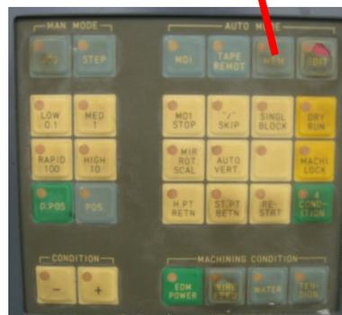
Sélection de mode, d'opération et de conditions d'usinage
