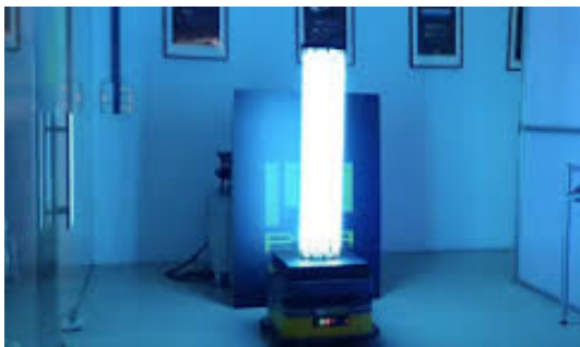
Document 2 : Robot en mode actif, et éclairage UVC au maximum.
